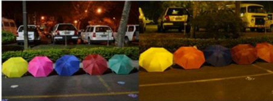
Figura 1 - Comparativo entre duas fontes luminosas com diferentes IRC's.
